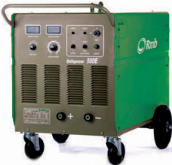
La soldadora Delta Power 500E es un rectificador de corriente continua, se utiliza principalmente como fuente de alimentación de la soldadura por arco manual y para repelado por arco de carbón.
